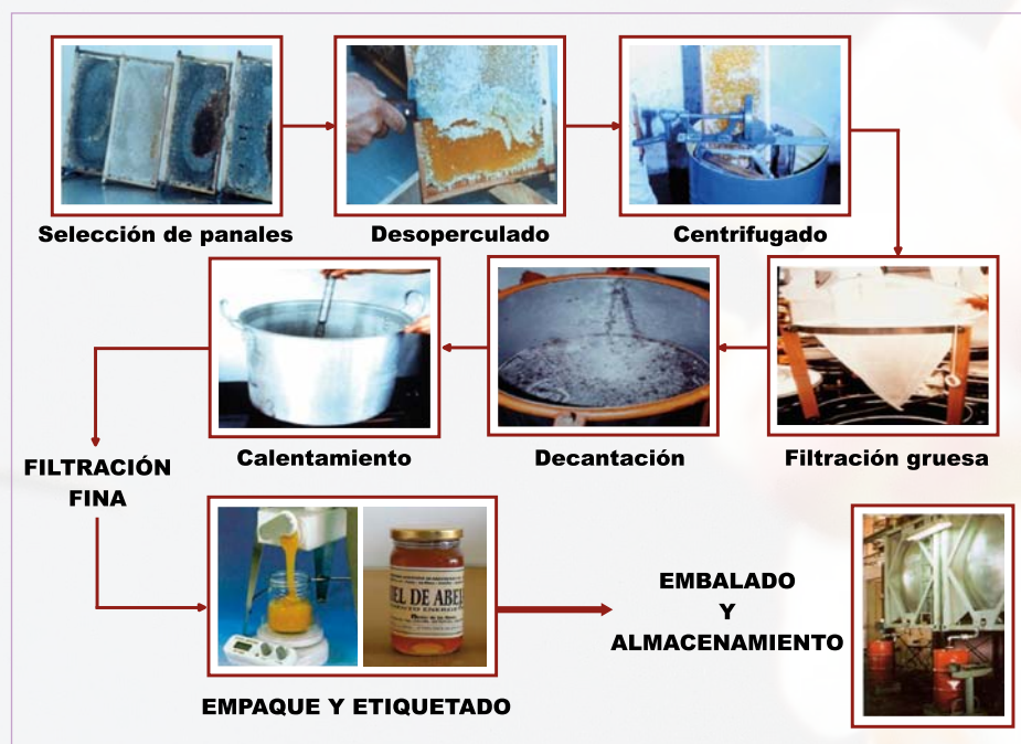
Figura 38. Diagrama de flujo del Beneficio de la miel
