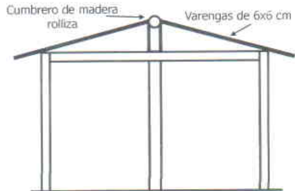
Figura 19. Techo a dos aguas
