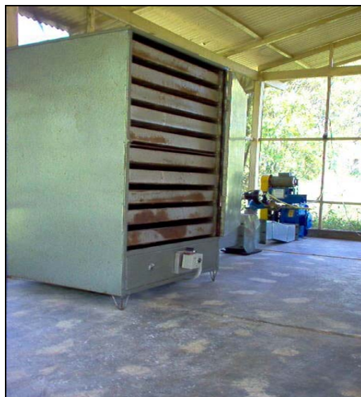
Figura 31. Secador de bandejas de lecho fijo utilizado en las etapas de presecado y tostación.
