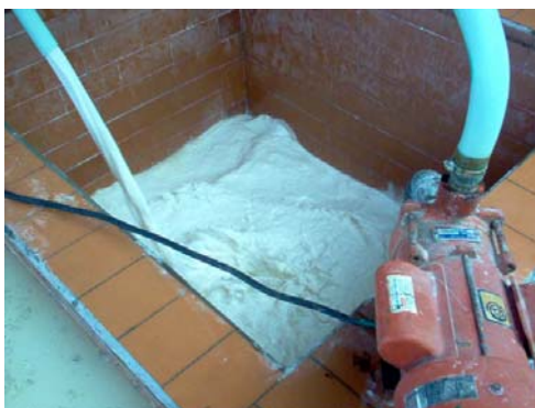
Figura 26. Mezclado de una suspensión de almidón con bomba mecánica.
