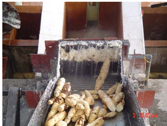
Figura 21. Rallado mecánico de raíces de yuca.
