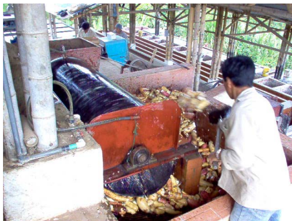
Figura 20. Lavado mecánico de raíces de yuca.
