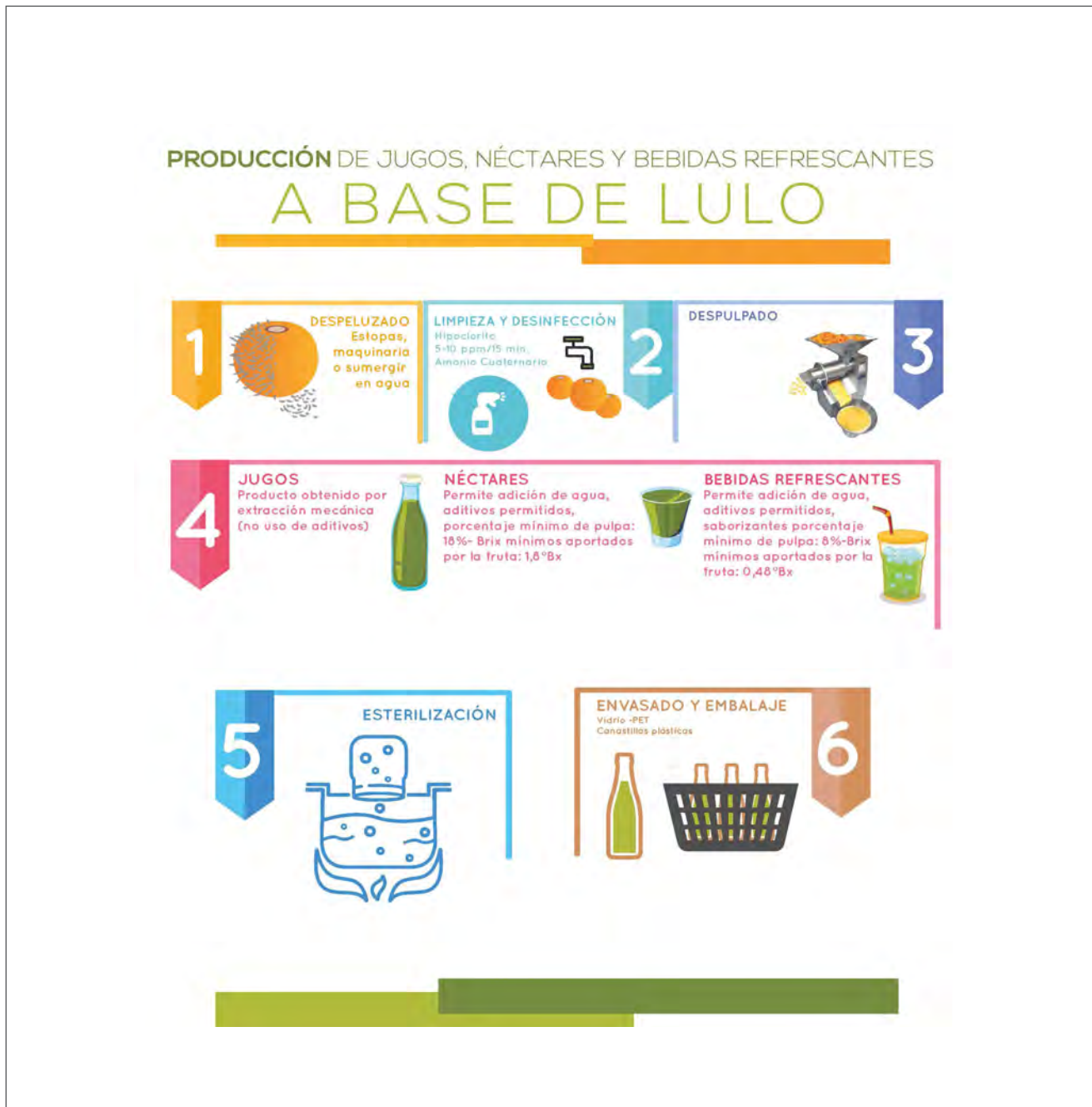
Figura 52. Flujo de producción de zumos, néctares y refrescos a base de lulo. Fuente: Juan Camilo Henao.
