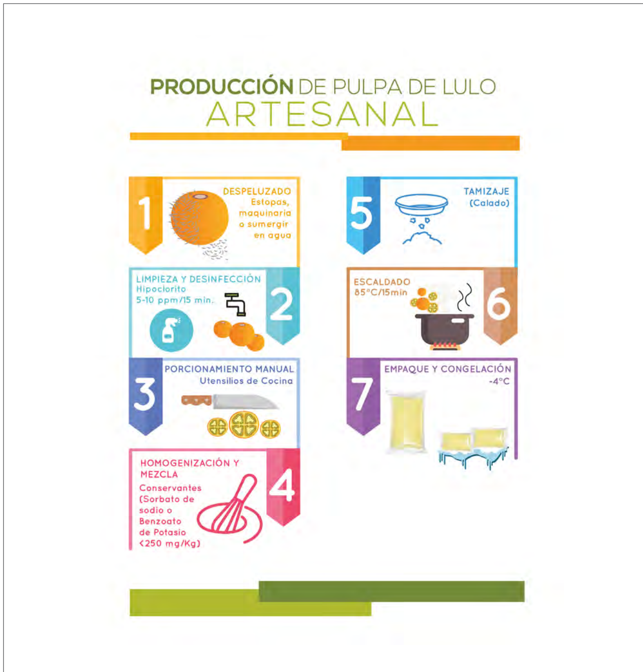
Figura 50. Flujo de producción de pulpa de lulo artesanal. Fuente: Juan Camilo Henao.
