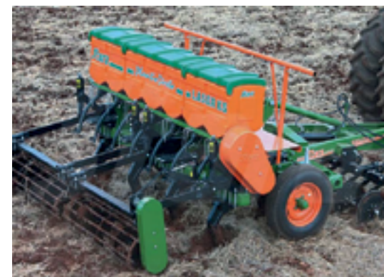
Figura 14. Sembrador renovador mecánico para siembra directa de pasturas
