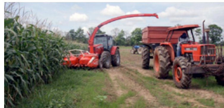
Figura 49. Cosecha mecánica de maíz para ensilaje.
