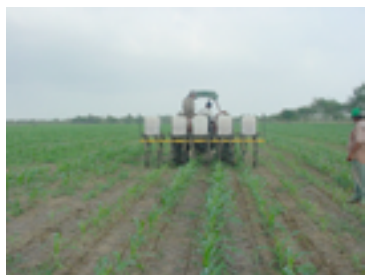
Figura 32. Abonadora mecánica para incorporar el abono en un cultivo de maíz
