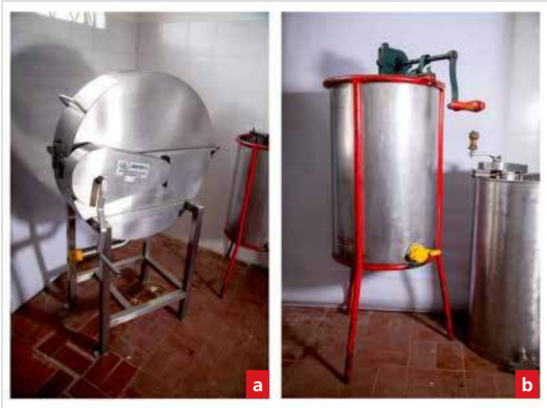
Figura 4.3. Centrífugas utilizadas en el beneficio de la miel. a. Manual radial; b. Manual tangencial de cuatro cuadros.
