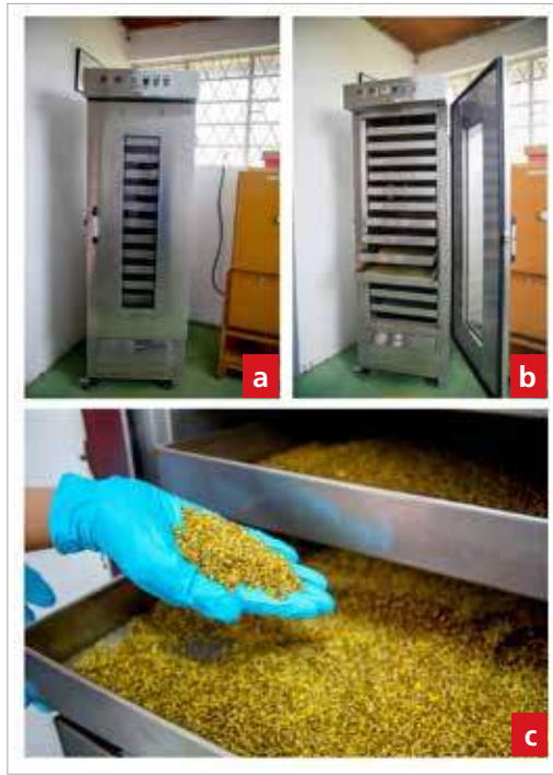
Figura 5.4. Secador de polen en acero inoxidable de grado alimenticio. a. Exterior del secador de polen; b. Interior del secador de polen; c. Polen al interior de un secador de polen.
