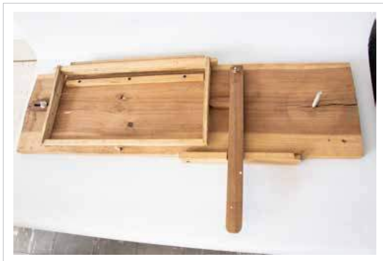
Figura 11.4. Sujetador de cuadros para la adhesión de cera.
