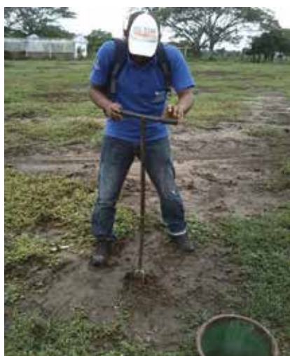
Figura 1. Toma de muestras de suelo con barreno.
