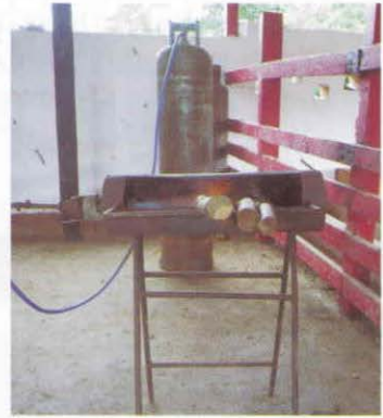
FOTOS 14 Y 15. IMPLEMENTOS PARA TOPIZAR Y MARCAR CON EL CALENTADOR A GAS
