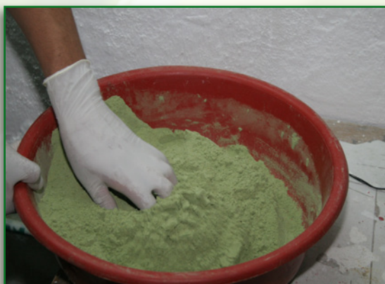
Foto 3. Acondicionamiento de la mezcla antes del proceso de extrusión
