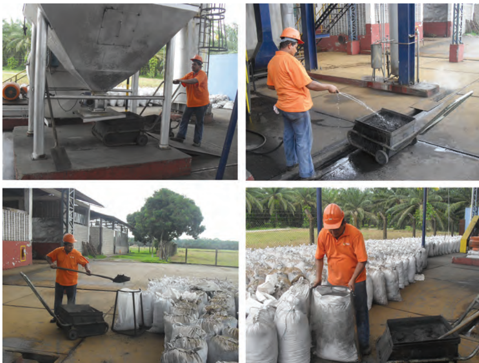
Figura 13 10 . Procedimiento para recolección de ceniza a la salida de la caldera.
