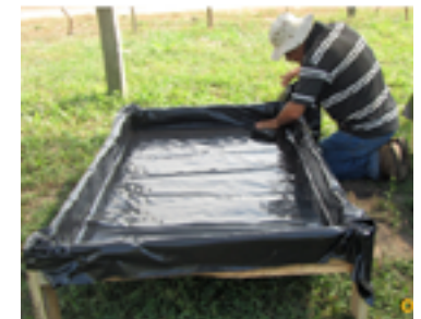
figura 3. Contenedor recubierto con plástico negro calibre 6
