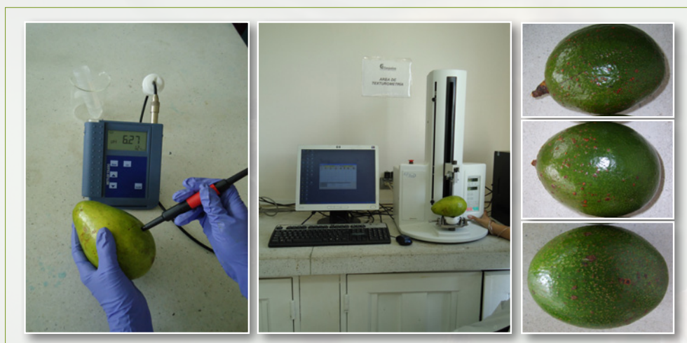
Foto 15. Evaluación de calidad física y química del fruto de aguacate, de izquierda a derecha: medida del pH con potenciómetro; medida de la resistencia de la cáscara con un texturómetro; frutos resultado del proceso de polinización dirigida con abejas Apis mellifera .
