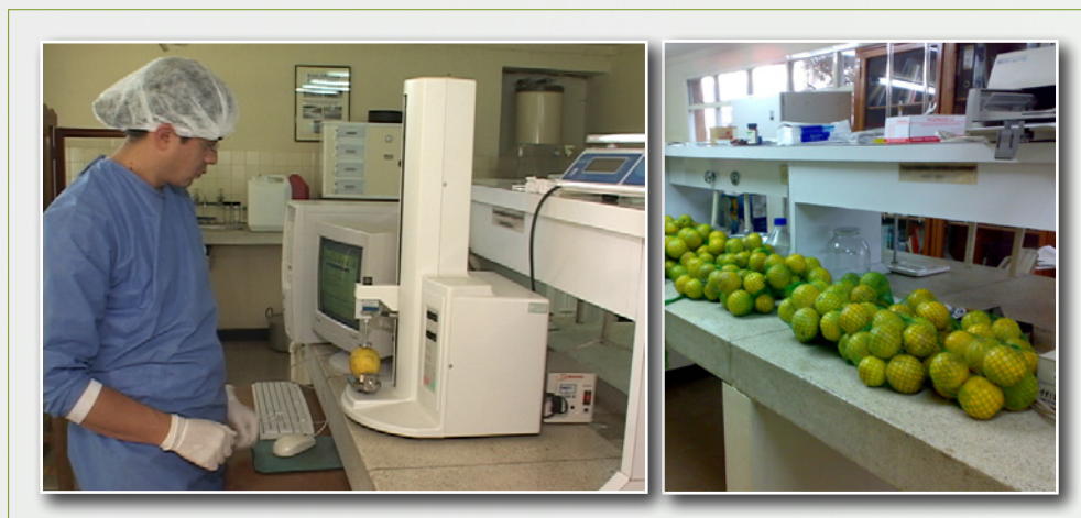
Foto 5. Evaluación de calidad física y química del fruto de naranja, de izquierda a derecha: medida de la resistencia de la cáscara con un texturómetro; naranjas tomadas de una empresa del departamento del Meta para su evaluación.
