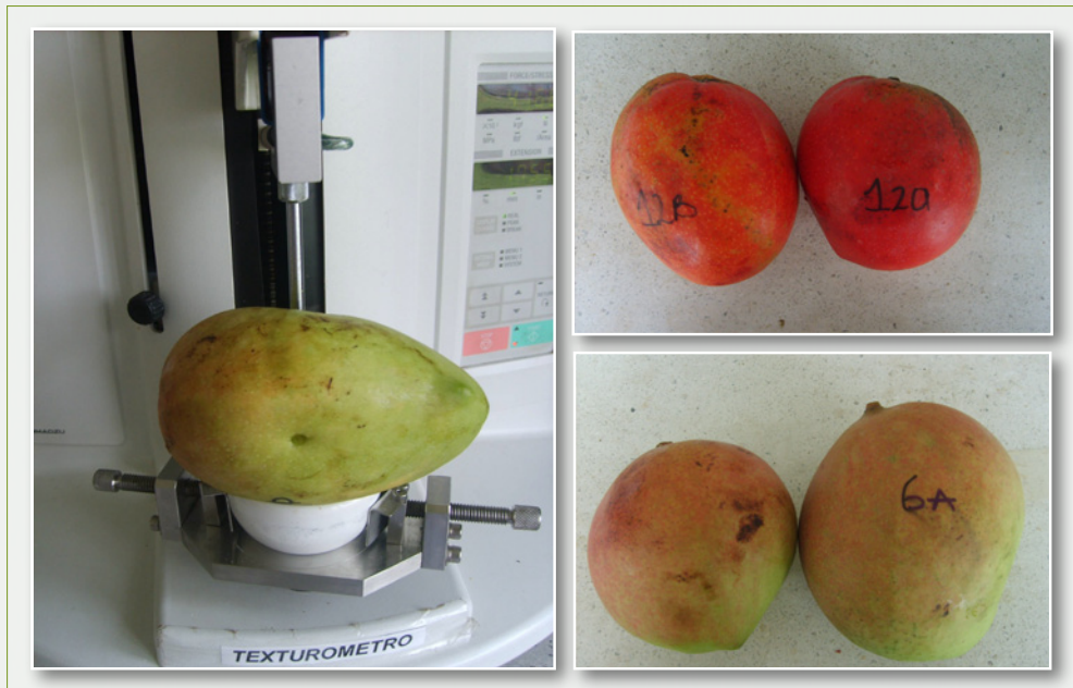
Foto 8. Evaluación de calidad física y química del fruto de mango, de izquierda a derecha: medida de la resistencia de la cáscara con un texturómetro; mangos tomados de una empresa del departamento del Tolima para su evaluación.
