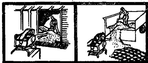
Fig. No. 7.2- Descarga con pala mecanizada
