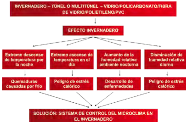
Figura 2.2. Efecto invernadero y control climático
