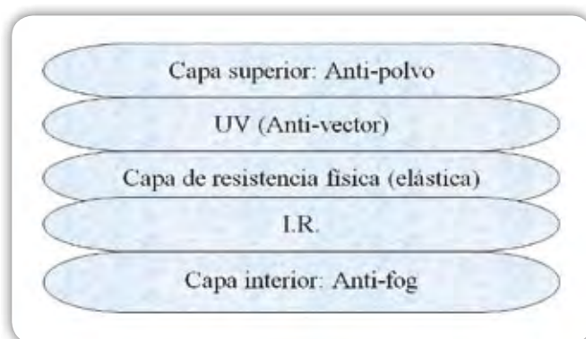
Figura 1.21. Diferentes capas de aditivos en una cubierta plástica (Shany, 2007)
