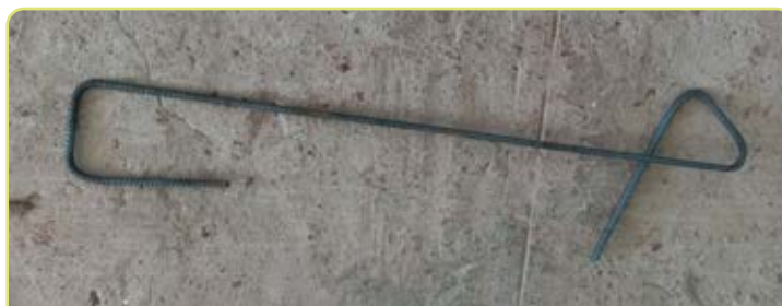
Figura 4.18. Tensor para la estructura del túnel en tubo galvanizado.
