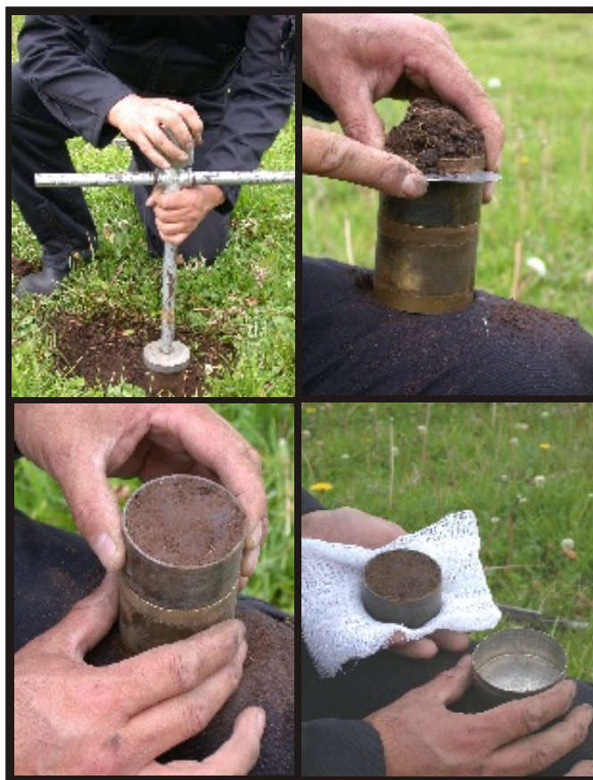
Figura 1.2. Toma de muestra de suelo para análisis físico
