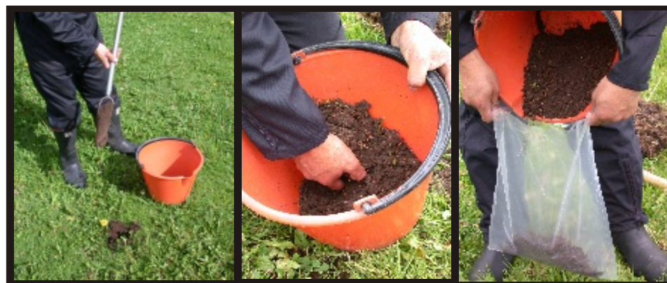
Figura 1.1. Implementos para la toma de la muestra y muestreo del suelo para análisis químico
