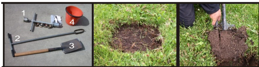
1). Muestreador para densidad aparente, 2). Barreno holandés, 3). Pala, 4). Balde plástico
