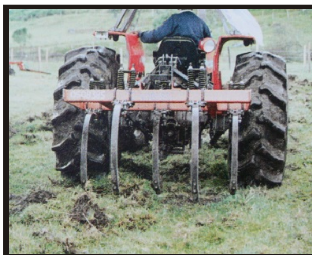
Foto 2.1 Arados de cincel fijo y vibratorio usados en procesos de preparación del suelo y en renovación de praderas
