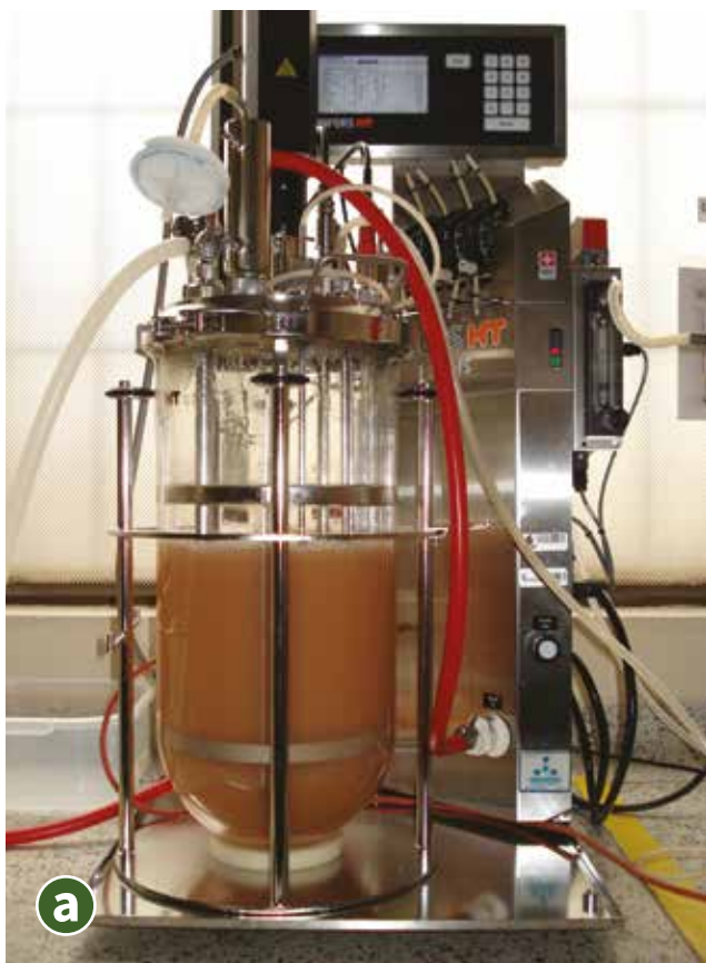
Figura 12.5. Biorreactores de tanque agitado (STR) usados para la producción de bioplaguicidas. a. Biorreactor escala laboratorio de 10 litros; b. Biorreactor escala piloto de 100 litros.
