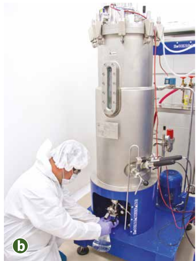
Figura 12.5. Biorreactores de tanque agitado (STR) usados para la producción de bioplaguicidas. a. Biorreactor escala laboratorio de 10 litros; b. Biorreactor escala piloto de 100 litros.
