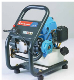
Figura 33. Aspersores utilizados en los experimentos con T. koningiopsis Th003 para estudiar la cobertura en la superficie foliar del tomate. Fumigadora de espalda operada manualmente con bomba de pistón (Izquierda), fumigadora motorizada estacionaria con bomba de pistón (derecha).
