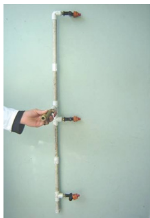
Figura 34. De izquierda a derecha, lanza curva convencional con válvula, aguilón artesanal en PVC con tres salidas, boquilla TeeJet TXVK-6 acoplada al aguilón.
