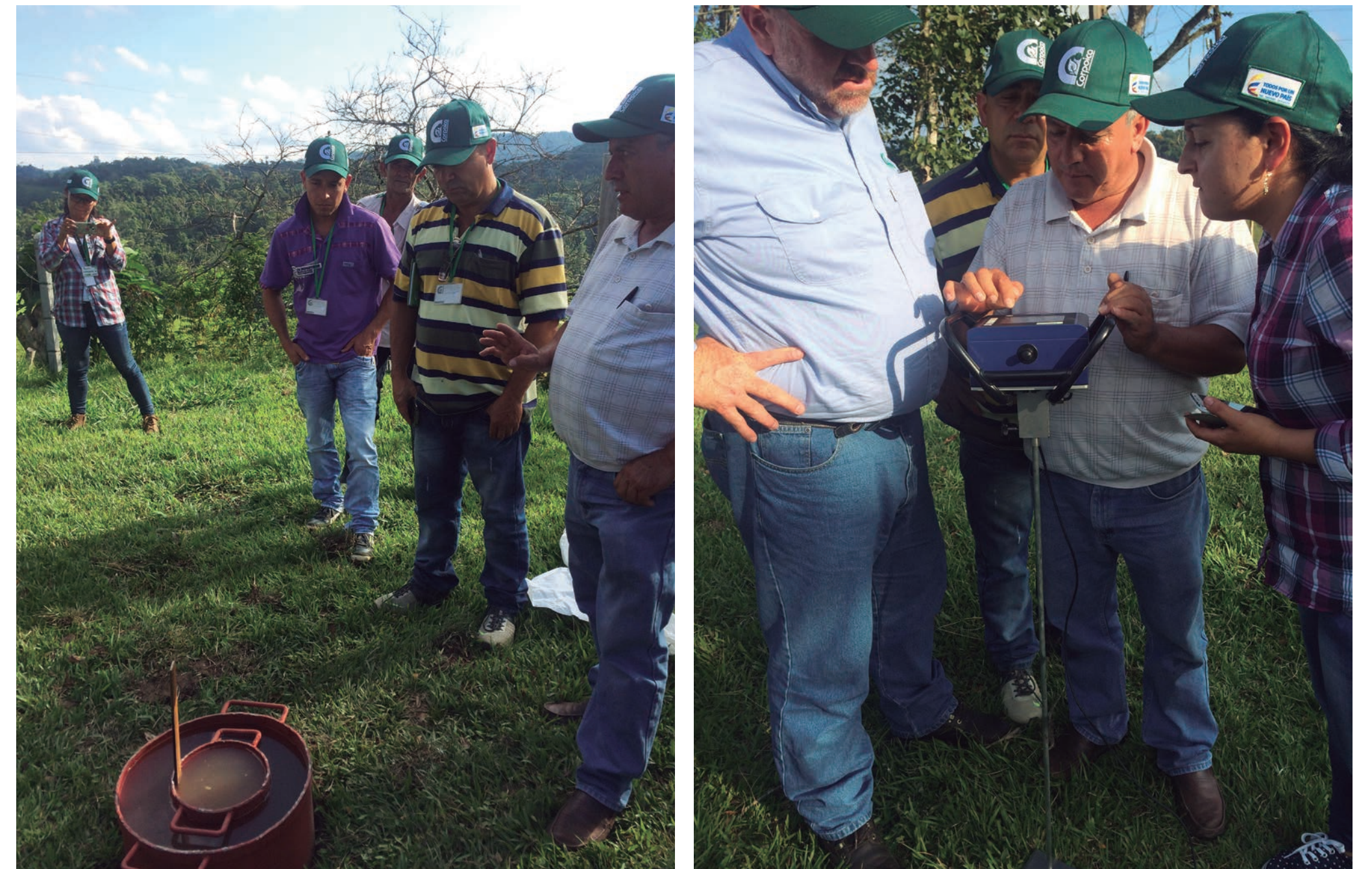
Figura 1: Práctica de campo relación suelo – agua, método anillos de infiltración de agua y penetrómetro
