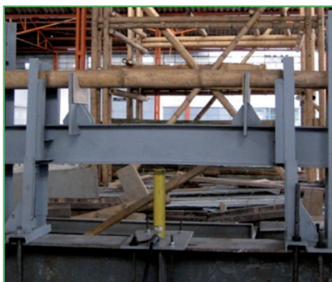
Montajes de ensayos: 1) ensayo a flexión, 2) ensayo a compresión perpendicular a la fibra
