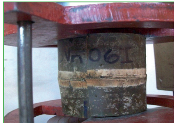
Ensayo para la determinación de la resistencia al corte paralelo a la fibra: 1) falla probeta sin nudo, 2) falla probeta con nudo
