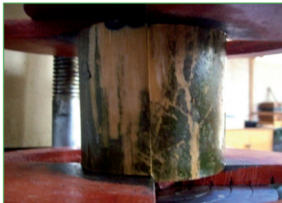
Ensayo para la determinación de la resistencia al corte paralelo a la fibra: 1) falla probeta sin nudo, 2) falla probeta con nudo
