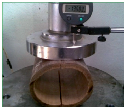
Montajes de ensayos: 1) ensayo a flexión, 2) ensayo a compresión perpendicular a la fibra
