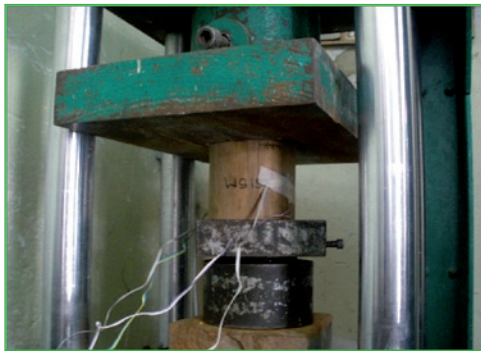
Ensayo para la determinación de la resistencia: a compresión paralela a la fibra
