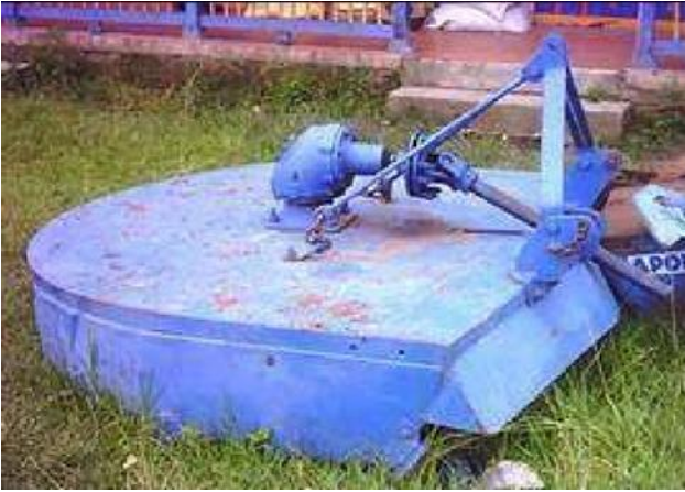
Figura 23. Cortamaleza de alce hidráulico de tres puntos. Tomado de Polanco (2007).
