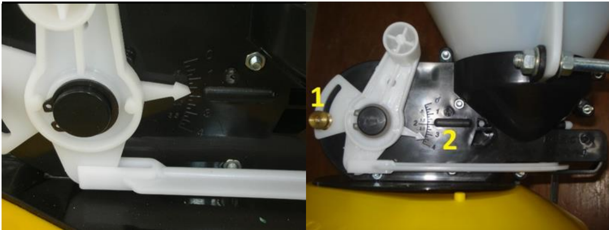
Figura 29. Calibración de la maquina sembradora. Derecha, botón de seguridad para calibrar la máquina. Izquierda, 1. Tuerca de seguridad. 2. Implemento para graduación de la sembradora.
