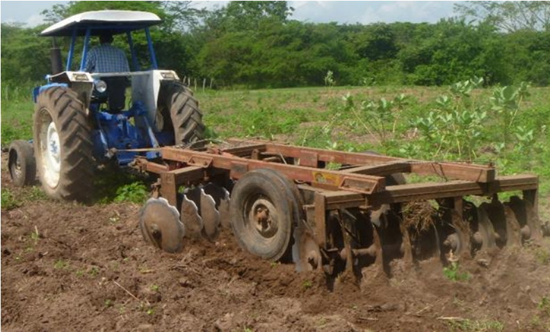
Figura 24. Rastra pesada en funcionamiento
