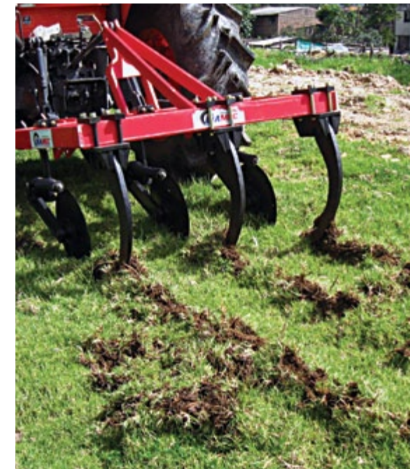
Figura 2. Renovador de pradera (rompe la compactación y restituye la circulación de aire y agua en el suelo. Corpoica 2012)
