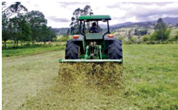
Figura 3. Desbrozadora (rompe en partículas pequeñas los colchones del material vegetal y los residuos, protegiendo el suelo y aportando nutrientes). Corpoica 2012
