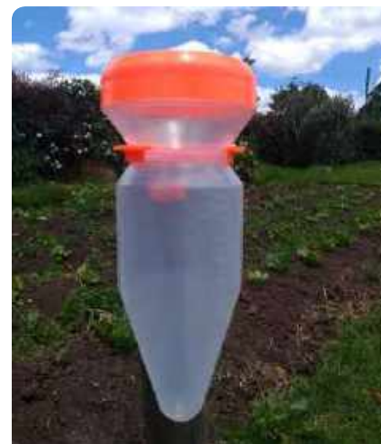
Figura 31. Pluviómetro tipo San Isidro, con el cual se mide el volumen de precipitación. Foto: Ivonne Trisancho.
