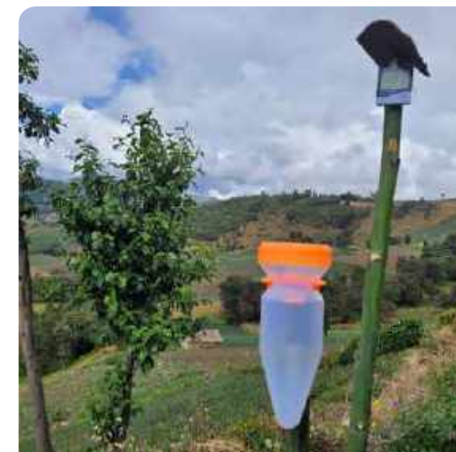
Figura 9. Estación de monitoreo agroclimático participativo con pluviómetro y medidor de temperatura y humedad. Foto: Ivonne Trisancho.
