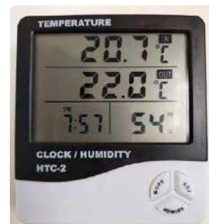
Figura 32. Termohigrómetro HTC-2, que registra temperatura y humedad relativa máxima y mínima. Foto: Douglas Gómez.
