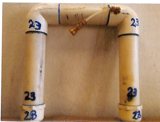
Imagen 1. Canister en forma "U" con manguera flexible, utilizado en el ensayo animal.
