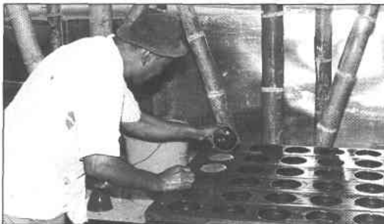
El moldeo debe realizarse rápidamente para evitar que se seque la masa.
