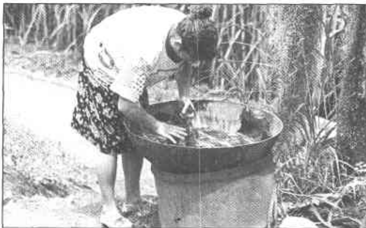
Para descachazar el jugo se le agrega balso o cadillo bien espeso mezclado con agua, este recoge la mugre o cachaza negra.
