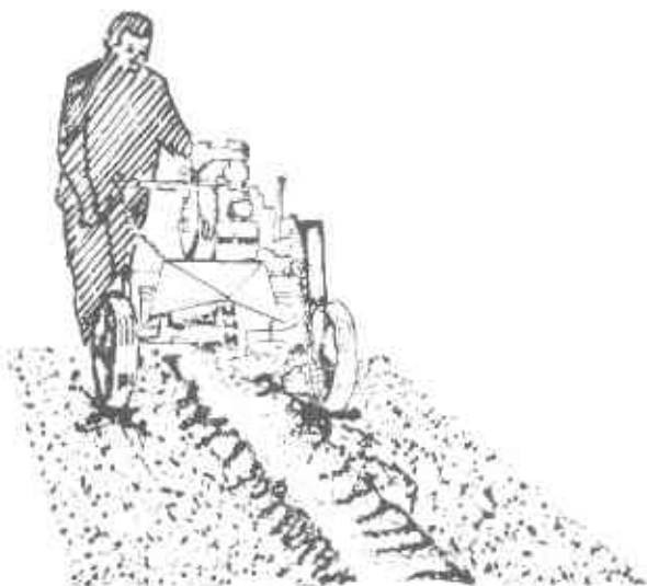
Figura 62. Zanjadora manual para sangrías internas en cultivos ya establecidos (ideal para plátano)
