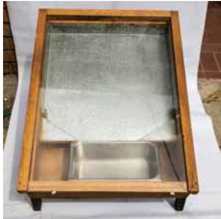
Figura 6.3. Certificador solar para la extracción de la cera.
