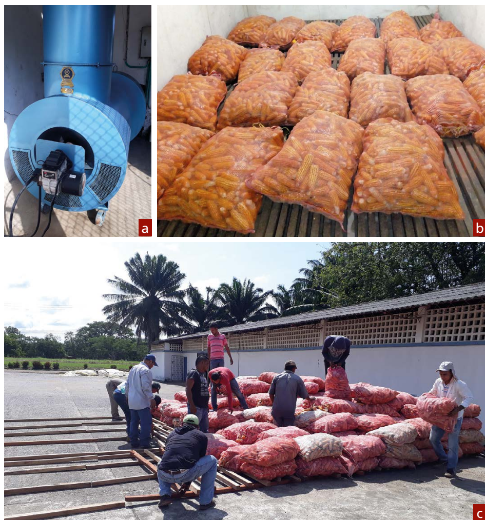
Figura 16. Secado de mazorcas. a. Quemador industrial para secado artificial; b. Cuartos de secado; c. Exposición de mazorcas al sol utilizando estibas de madera.
