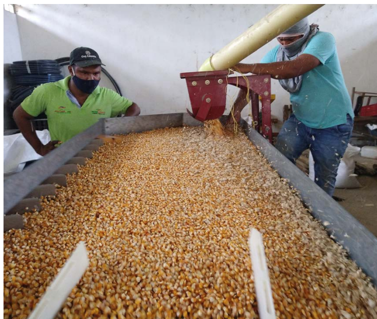
Figura 21. Mesa de gravedad utilizada para limpiar y clasificar la semilla de maíz.
