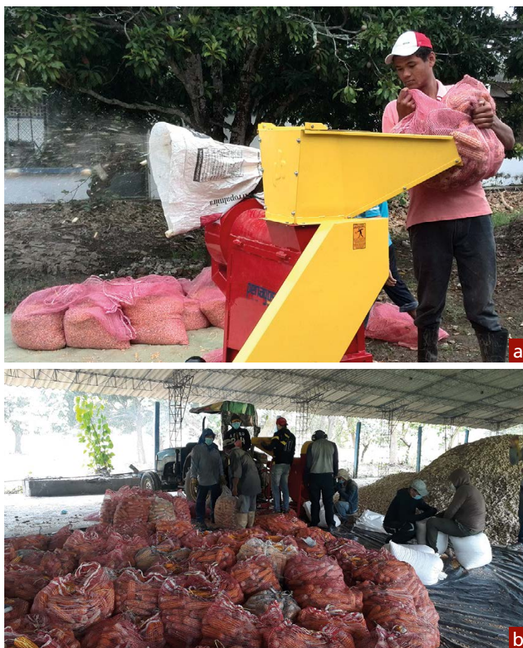
Figura 17. Desgrane mecánico de las mazorcas. a. Desgrane de las mazorcas mediante una desgranadora mecánica con motor de combustible; b. Desgrane de mazorcas con una desgranadora acoplada al tractor.
