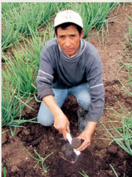
Toma de muestra inalterada para determinación de la retención de humedad del suelo.
