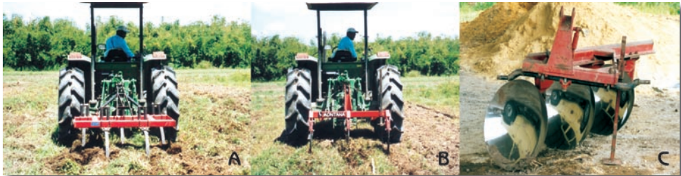
Figura 1. A: Arado de cincel vibratorio. B: Arado de cincel rígido. C: Arado de discos.
