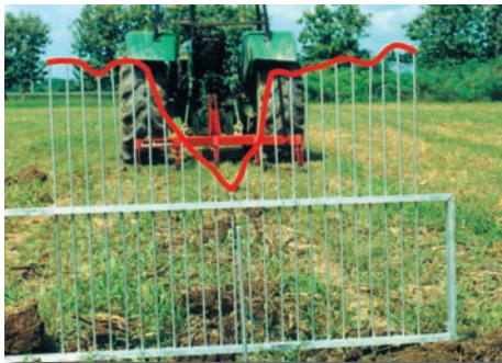
Figura 3. Perfil del suelo trabajado con el arado de cincel rígido
