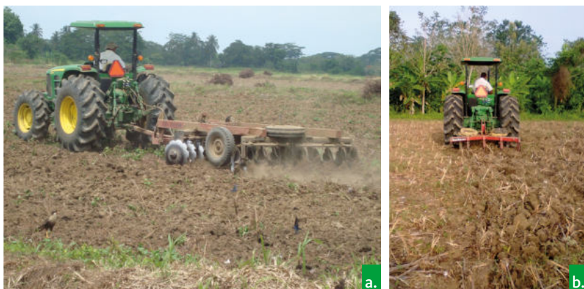
Figura 3. Tipos de labranza convencional utilizados para el cultivo de maíz. a. Labranza con arado de discos; b. Labranza con arado de cincel.
