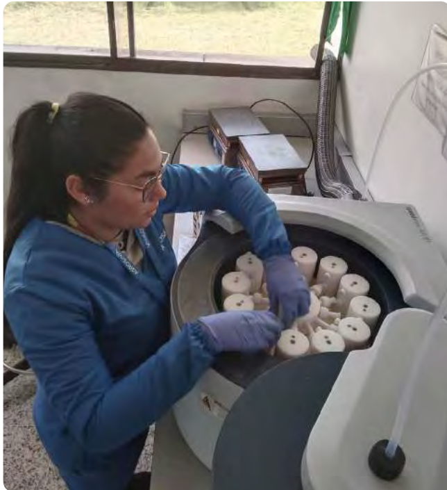
Figura 4.8. Paso 3. Digestión ácida de las muestras en un equipo microondas.
