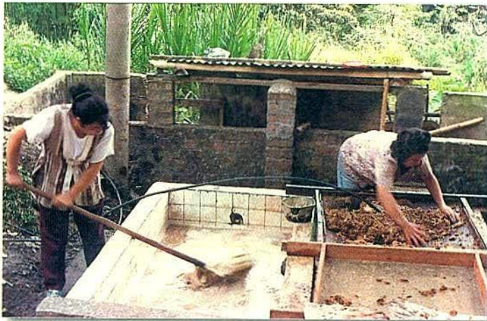
Foto 49. Montaje empleado tradicionalmente para tamizar la lechada.
