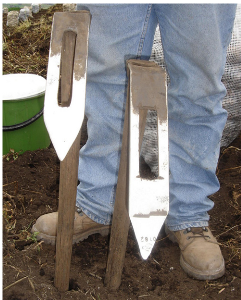
Figura 24 Herramienta denominada “gancho” utilizada en la cosecha de papa. Esta herramienta fue desarrollada por la creatividad de los cosecheros o productores. Para su elaboración se utilizan las hojas de amortiguador desechadas de los camiones, y por ello existen de diferente longitud, entre otras variaciones. A estas secciones de hojas se les suelda el “ojo” o “anillo” de un azadón convencional, dentro del cual se empata el “palo o cabo” del implemento, que no tiene una longitud superior a los 70 cm. En los municipios productores del departamento este implemento de cosecha se encuentra para la venta en las ferreterías.
