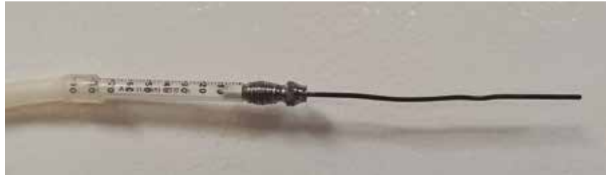
Figura 34. Aguja de gasificación de cánula en acero inoxidable.
