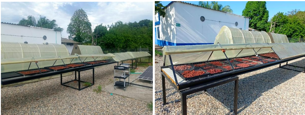
Ilustración 1. Prototipo de túnel de secado Hohenheim – Centro de Investigación Nataima, AGROSAVIA.
