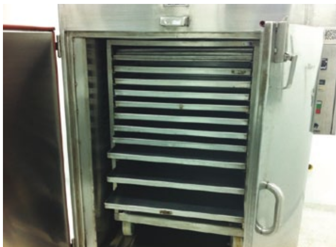
Figura 1. Cámara con convección forzada de aire para la fermentación en estado sólido de L. lecanii VIO26.
