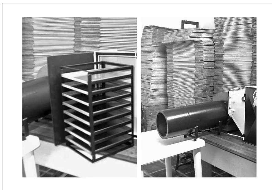
Figura 1. Equipo de secado estático construido para las pruebas de deshidratación de pulpas de fruta en lámina.
