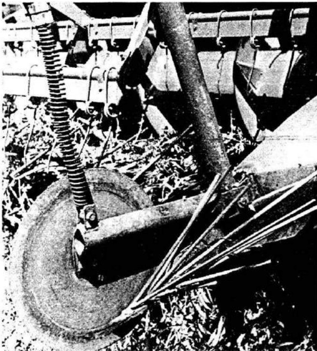
Disco de corte adaptado no lado direito da barra de corte da penha CLC 500
