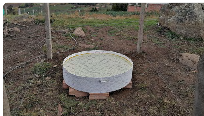
Figura 50. Instalación de tanque de evaporación en Asosanantonio.
