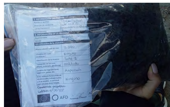
Figura 40. Empaquetado y rotulado de muestra de suelo.
