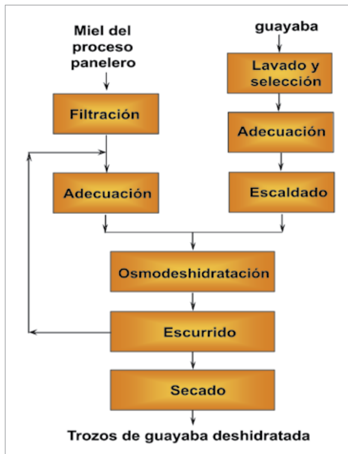
Figura 1. Diagrama del proceso de osmodeshidratación de guayaba con miel o jarabe de panela
