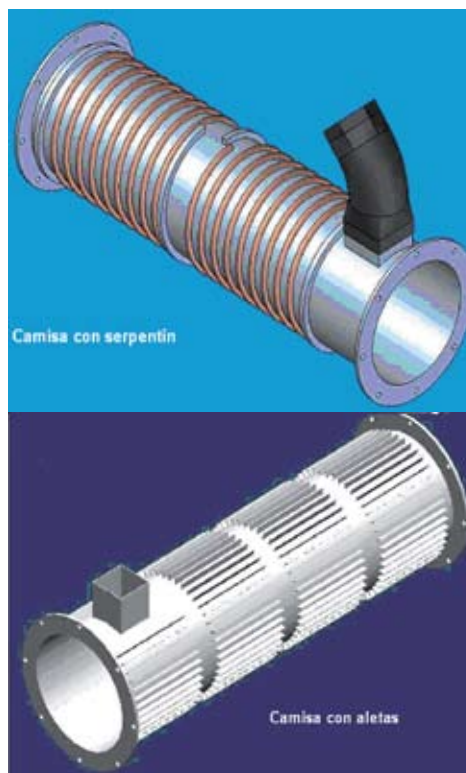
Figura 3. Sistemas de camisa con serpentín y con aletas, probados en el prototipo del sistema de enfriamiento de pulpas de guayaba
