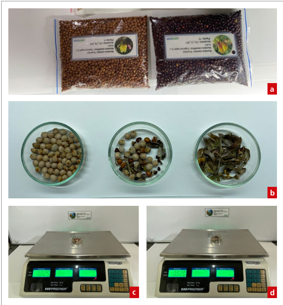
Figura 14. Proceso para realizar el análisis de pureza física. a. Identificación de la muestra de trabajo de semillas de guandul que pesan 960 g; b. Separación de la muestra de trabajo en las fracciones semilla pura, otras semillas y materia inerte; c. Otras semillas = Y (0,025 kg o 25 g); d. Materia inerte = Z (0,020 g o 20 g).
