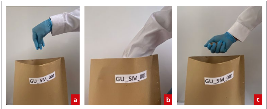
Figura 12. Muestra primaria de semilla. a. Introducir la mano cerrada y abrirla dentro de la bolsa; b. Cerrar la mano con un puñado de semillas; c. Retirar la mano con el puño cerrado y la muestra de semillas.
