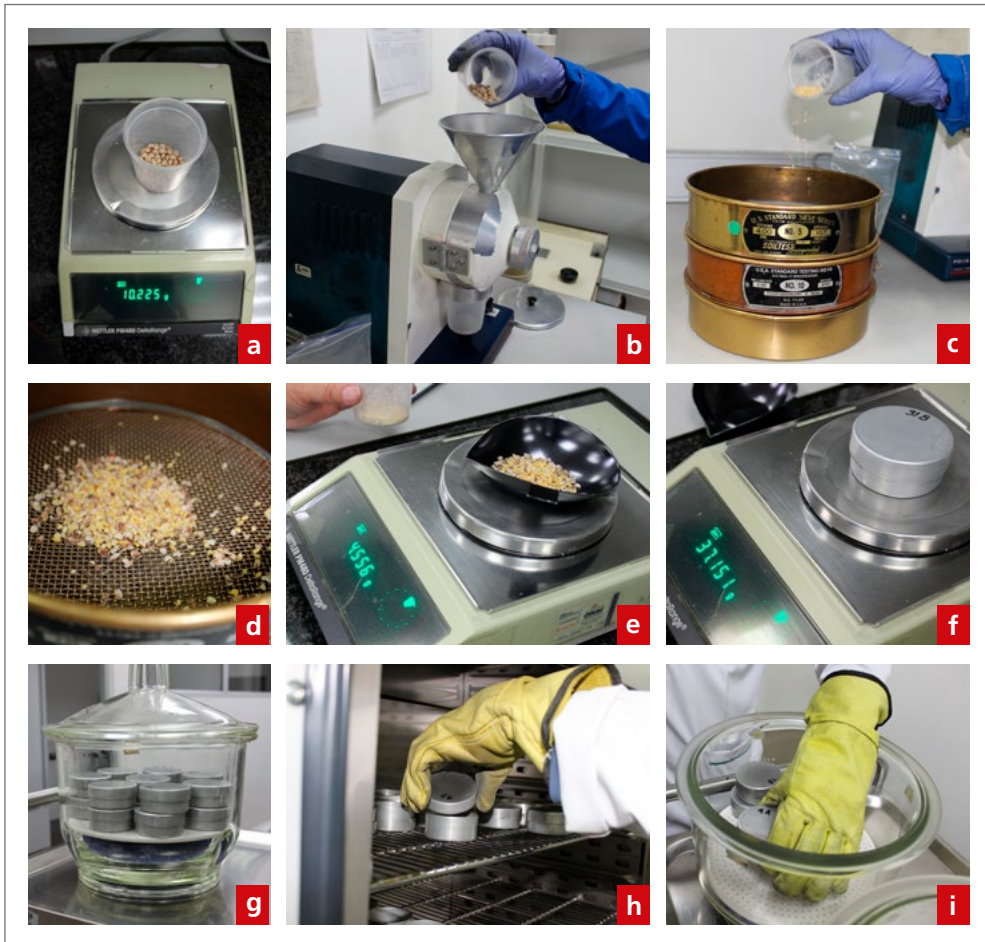
Figura 15. Procedimiento para determinar el contenido de humedad en semillas de guandul. a. Pesaje de la muestra de semilla que se va a moler; b. Molienda de la muestra de semilla; c. Tamizado de la muestra de guandul; d. Residuo de la molienda en el tamiz de 2 mm; e. Pesaje del residuo del tamiz denominado 4,5 g; f. Pesaje del residuo del tamiz en recipiente metálico denominado P1 = 36,3; g. Extracción de la humedad de la muestra en olla con sílice gel; h. Secado en horno de la muestra a 130 °C; i. Secado de la muestra en olla con sílice gel por 30 minutos.
