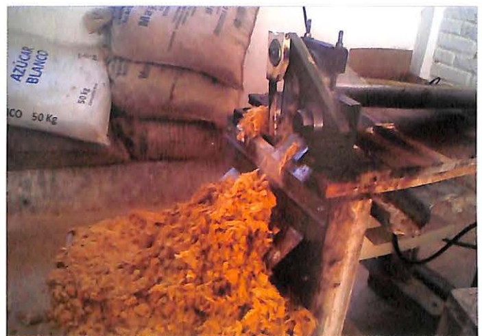
CORTE DE FIBRA A 1 CENTÍMETRO
