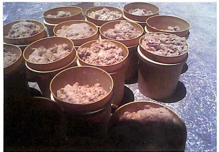
CORTE DE FIBRA A 1 CENTÍMETRO
