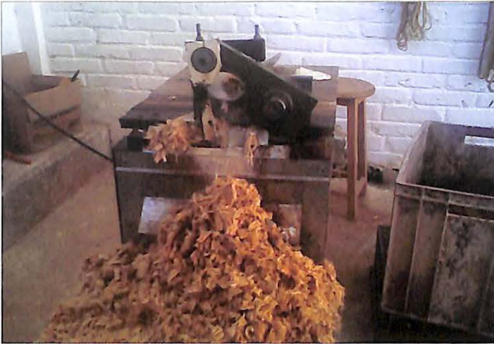
LA FIBRA ES COLOCADA EN UNA CENTRIFUGA PARA SEPARAR LAS FIBRAS.
