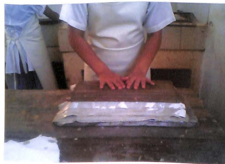
SEPARACIÓN DE LAS HOJAS CON LAS LAMINAS DE METAL
