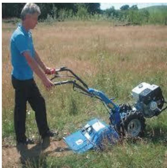
Figura 54. Muestra de un Rotavator manual para control de arvenses en cultivo establecido
