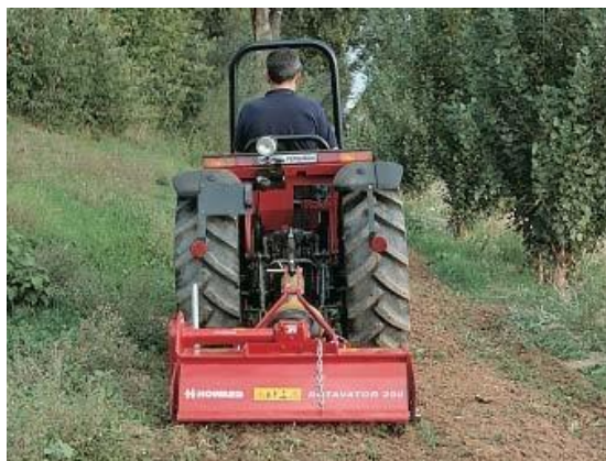
Figura 53. Muestra de un Rotavator operando en campo para control de arvenses
