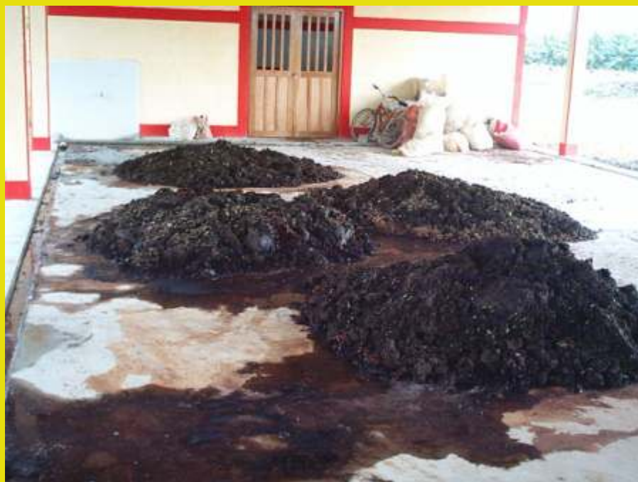
Lodo séptico en tratamiento
