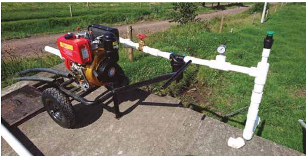
Motobomba centrífuga modelo 15AQ/F300 de 6,7 HP (línea HY-FLO™) monoblock diesel.
