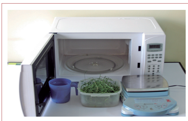
Figura 9. Determinación de la materia seca en horno microondas.
