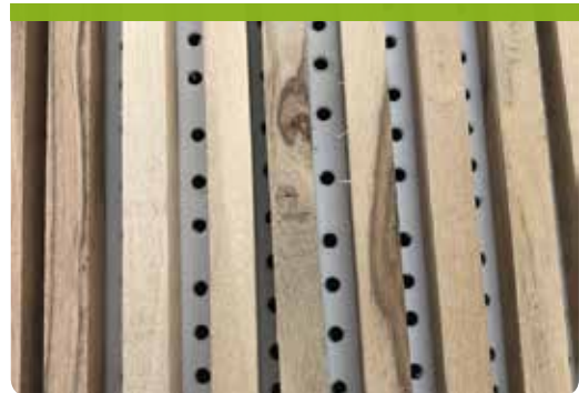
▲ Defectos en los listones, con distancias irregulares.
