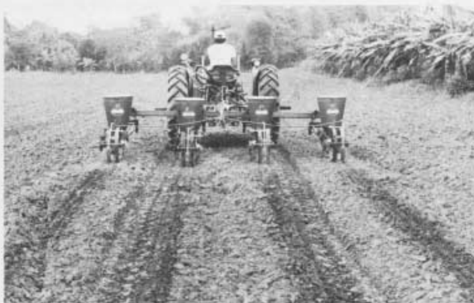
FIGURA 3. Labor simultánea de siembra y aplicación de un herbicida pre-emergente en bandas.
