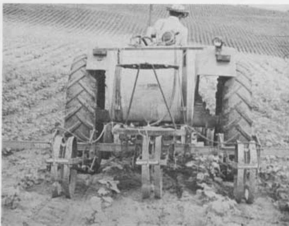
FIGURA 4. Equipo acoplado a la sembradora para aplicar post-emergentes medianos.
