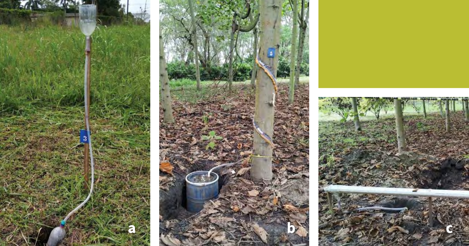
Figura 10. Pluviómetros para cuantificar la precipitación en plantaciones forestales. a. Pluviómetro en abierto; b. Pluviómetro cortical; c. Pluviómetro lineal. Fotos: Jhon Jairo Zuluaga Peláez
